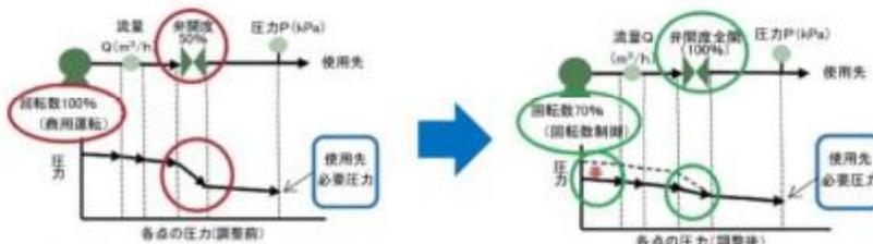
図 インバータ周波数調整の考え方
